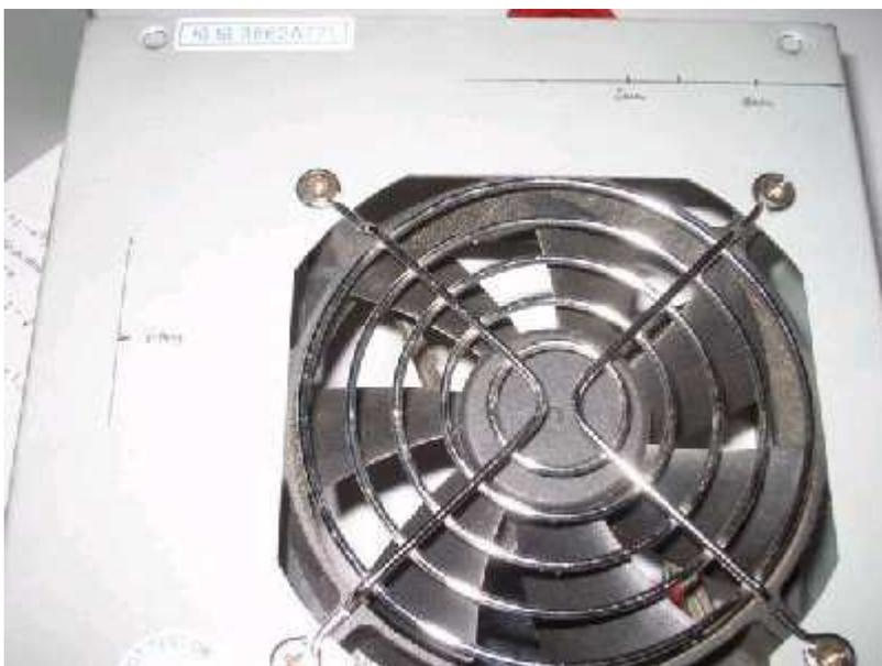
Respecto a la colocacion de los leds en la chapa de la fuente, si realizamos los agujeros muy precisos con el diametro del led, podremos mantenerlos fijos sin tener que pegarlos o buscar otro tipo de soluciones. O si quereis darle un mejor acabado, en las tiendas de electronica, podemos adquirir junto con los leds "porta leds" con los que nos sera más facil su colocacion, y no tendremos que ser tan precisos a la hora de taladrar.
