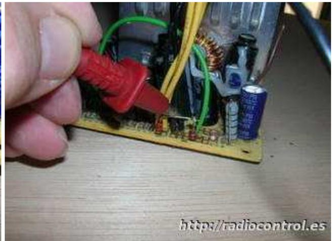
Ahora preparamos nuestra red de realimentación. Soldamos una patilla de la resistencia de 2K7 a un pad de masa y una patilla de la resistencia de 12K (si la referencia es de 2.5V) o de 4K7 (si la referencia es de 5V) a un pad de +12V. Las patillas libres de ambas resistencias las soldamos juntas.
