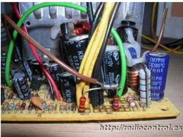
De nuevo tenemos que desconectar la fuente y desmontarla de su chasis para localizar el pin 1 del controlador. Una vez lo tengamos correctamente identificado, cortaremos la pista que lo une a la realimentación de la línea de 5V.
